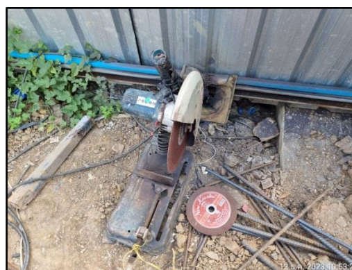
รูปที่ 33 ใช้วัสดุป้องกันการคันสะเทือนหุ้มด้ามเครื่องมือ
