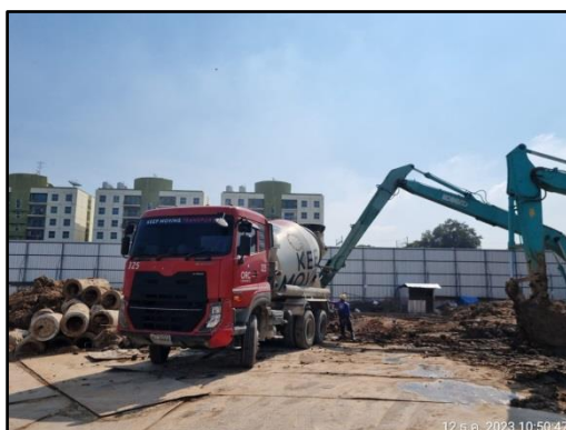
รูปที่ 13 รถคอนกรีตผสมเสร็จ
